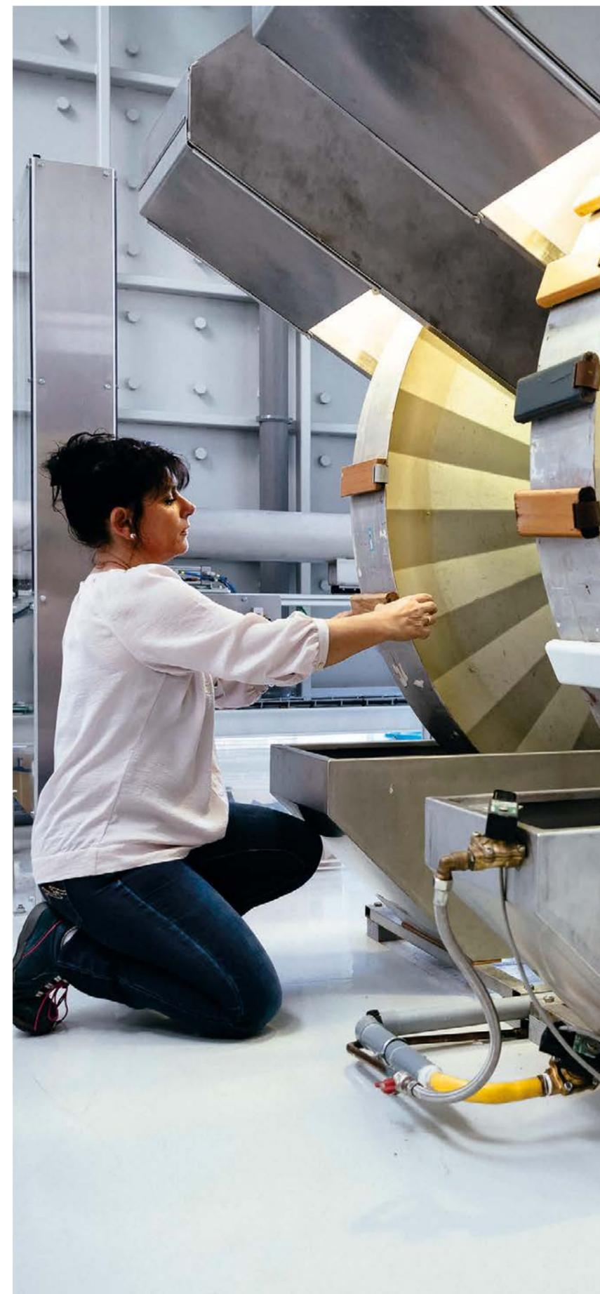
Test d'usure des portes d'entrée sur la roue de vieillissement au laboratoire CETIH.
