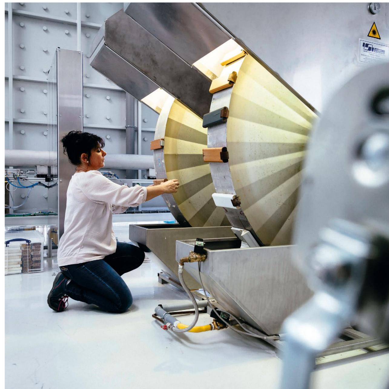
Test d'usure des portes d'entrée sur la roue de vieillissement au laboratoire CETIH.
